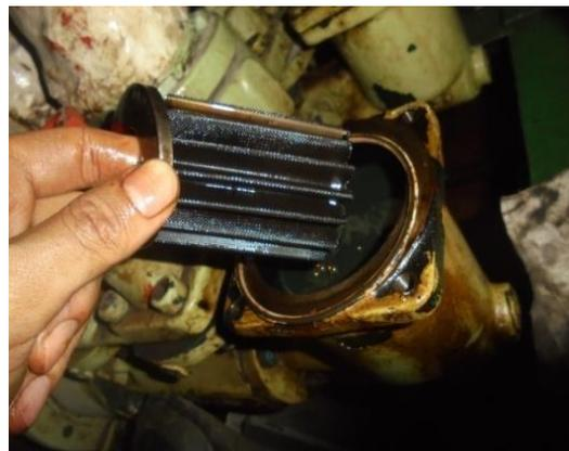
**Gambar 3 Kotornya strainer pada pesawat incinerator**
