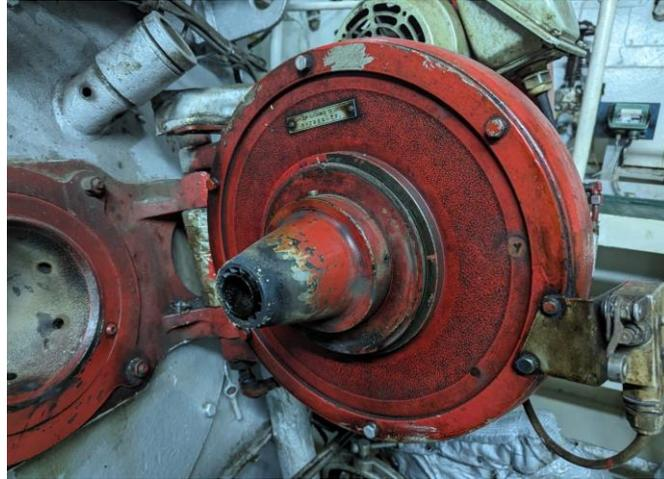
Gambar 1 *Main Burner Pesawat Incinerator*
