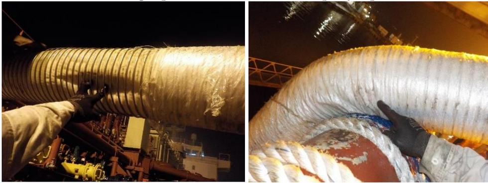
Gambar 2. Kondisi *hose* setelah mengalami *overpressure*
