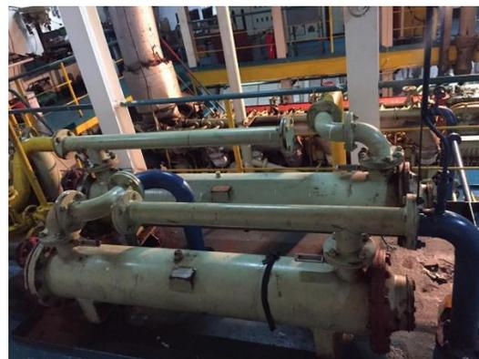
Gambar 3. *Fresh Water Cooler* pada Kapal KM. Abadi Sejahtera
