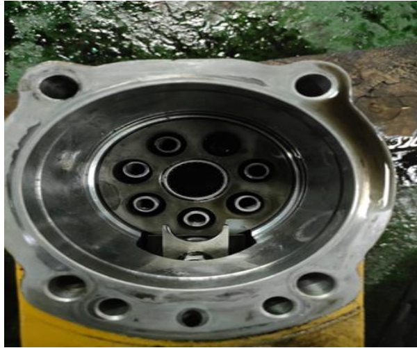
Gambar 7. Dinding pompa heui pump aus karena gesekan dari patahan
