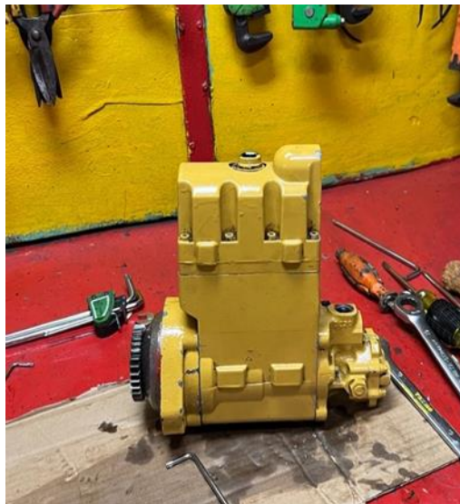
Gambar 4. Heui pump yang mengalami kerusakan
