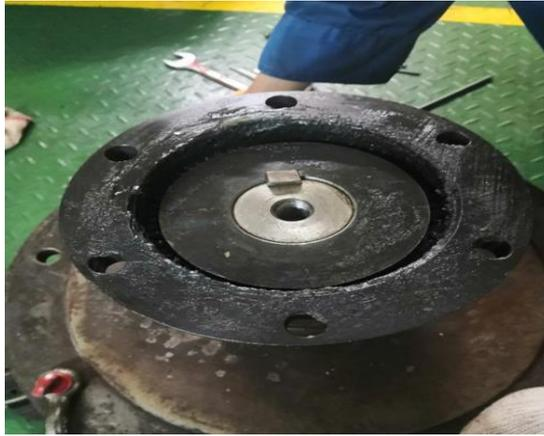
Gambar 3. *Gear Coupling Ballast Pump* Setelah Diganti
