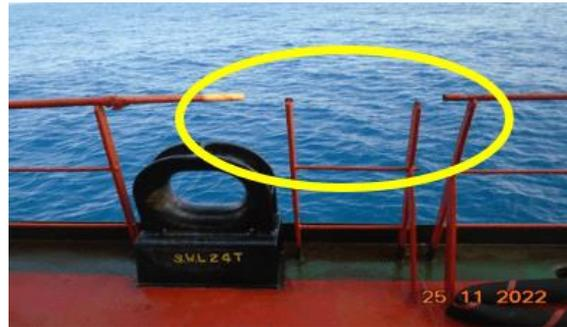
Gambar 8. Kerusakan pada *Railing* Kapal
